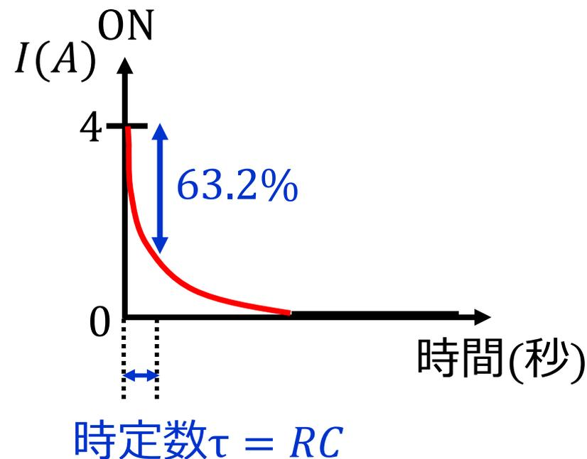
コンデンサの電荷が放電によって徐々に減っていき、電流もそれに比例して下がる。
